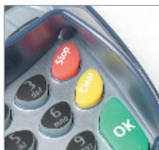
Tastatur mit ergonomischem Sichtschutz und taktilen Symbolen
